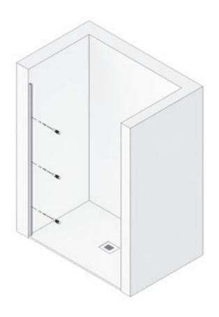
ATORNILLAR EL PERFIL EXPANSOR FIJO, FIJANDOLO CON TACOS DEL Nº 6 Y LOS 3 TORNILLOS 4.2X32
