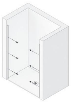
ATORNILLAR LOS PERFILES EXPANSORES, FIJANDOLOS CON TACOS DEL Nº 6 Y LOS 6 TORNILLOS 4.2X32.
