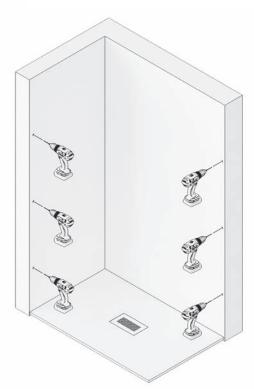
ATORNILLAR LOS PERFILES "U" A PARED, FIJANDOLOS CON TA-COS DEL Nº 6 Y LOS 6 TORNILLOS 4.2X32.
