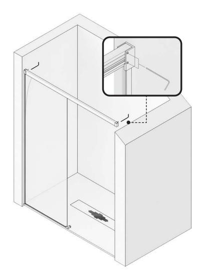
**COLOCAR LA GOMA INFERIOR** VIERTEAGUAS EN LA HOJA CORREDERA Y MONTARLA EN LOS RODAMIENTOS, INTRODUCIENDO LA MISMA EN LA PINZA GUIA INFERIOR. GRADUAR EN ALTURA Y NIVELAR, HACIENDO GIRAR EL EJE DE LA EXCENTRICA, MEDIANTE LAS TUERCAS DE REGULACION DE RUEDAS, CON DOS LLAVES FIJAS DE 20 MM., FIJANDOLA FUERTE-MENTE EN SU POSICIÓN.
