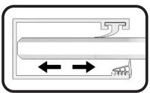
AJUSTAR EL JUEGO DE LOS VIDRIOS FIJOS SEGÚN NECESIDAD. FIJAR EL VIDRIO, ENGOMANDO EL CRISTAL CON EL PERFIL A PARED Y CON LA GUIA SUPERIOR.
