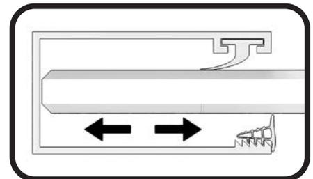
AJUSTAR EL JUEGO DEL VIDRIO FIJOS SEGÚN NECESIDAD. FIJAR EL VIDRIO, ENGOMANDO EL CRISTAL CON EL PERFIL A PARED Y CON LA GUIA SUPERIOR.
